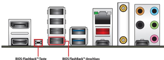
5. Warten Sie bis das Licht ausgeht, was bedeutet, dass die Aktualisierung des BIOS beendet ist.
