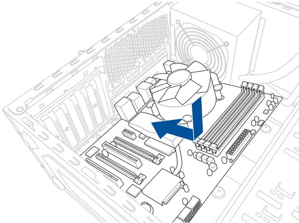
2. Setzen Sie sieben (7) Schrauben in die durch Kreise markierten Bohrlöcher ein, um das Motherboard im Gehäuse zu befestigen.
