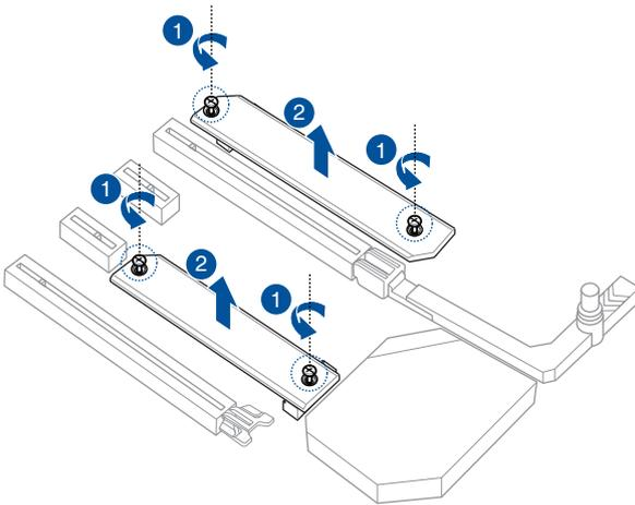
3. Installieren Sie Ihr M.2 in Ihrem M.2 Steckplatz. Die Schritte können bei der Installation von M.2 verschiedener Länge unterschiedlich sein. Bitte geben Sie auf die verschiedenen Typen und deren Installationsschritte unten acht:
