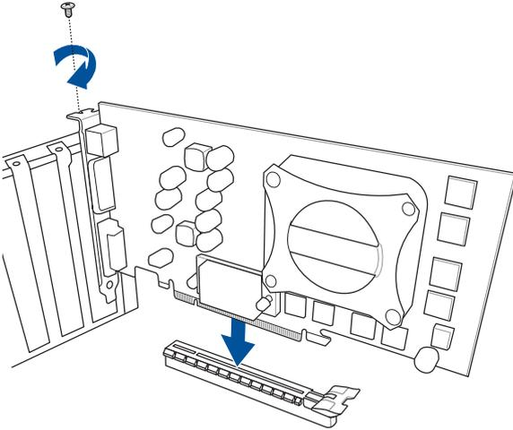
So installieren Sie eine PCIE x1 Karte
