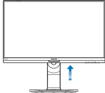
2. Platzieren Sie den Bildschirm mit dem Panel nach unten auf einem weichen Untergrund. Achten Sie darauf, dass der Bildschirm nicht zerkratzt oder beschädigt wird. Heben Sie den Ständer dann an.
