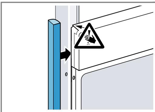
2. Aluprofile vorbohren, um eine Schraubverbindung herzustellen.
