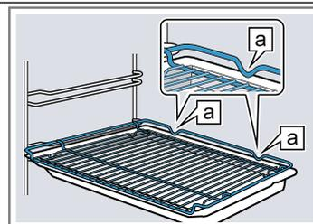
Rost Den Rost mit der offenen Seite zur Gerätetür und der Krümmung
