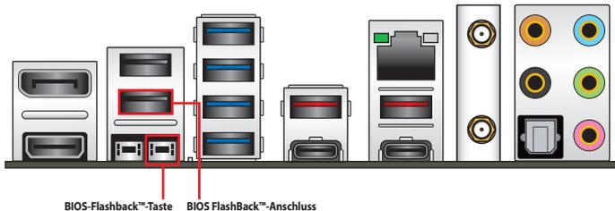
6. Warten Sie bis das Licht ausgeht, was bedeutet, dass die Aktualisierung des BIOS beendet ist.
